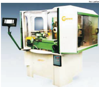
ASP-631F w wersji WL to czteroosiowa, numerycznie sterowana szlifiarka do automatycznego ostrzenia pił tarczowych.
