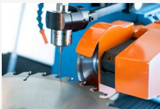
Sonda Renishaw do precyzyjnego pomiaru zębów
